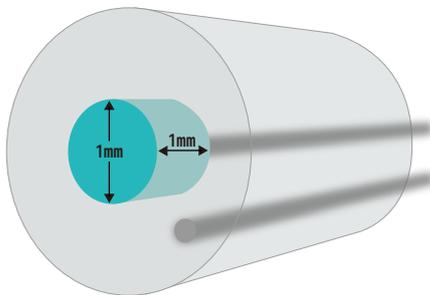
蛍光材を添加した特殊なプラスチックシンチレータ（直径1mm × 長さ1mm）は、放射線が照射されると吸収したエネルギーを光に変換します。この光は光ファイバーを通じて光電子増倍管（PMT）に集められ、そこで光信号が電気信号に変換されます。その後、信号は増幅されデジタル化されることで、正確な線量測定が可能になります。X線用検出器では、検出器からPMTまで2本の光ファイバーが接続されています。1本はプラスチックシンチレータに接続されていますが、もう1本は接続していないため、この2本の信号の差を取ることで、ノイズ成分であるチェレンコフ光を確実に除去することができ、優れた信号対ノイズ比を実現します。陽子線や重粒子線での測定においては光ファイバーでチェレンコフ光が発生しないため、各検出器に対して1本の光ファイバーのみで2倍のチャンネル数を実装することが可能です。
